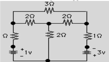
(d) Determine the z-parameters of fig.
